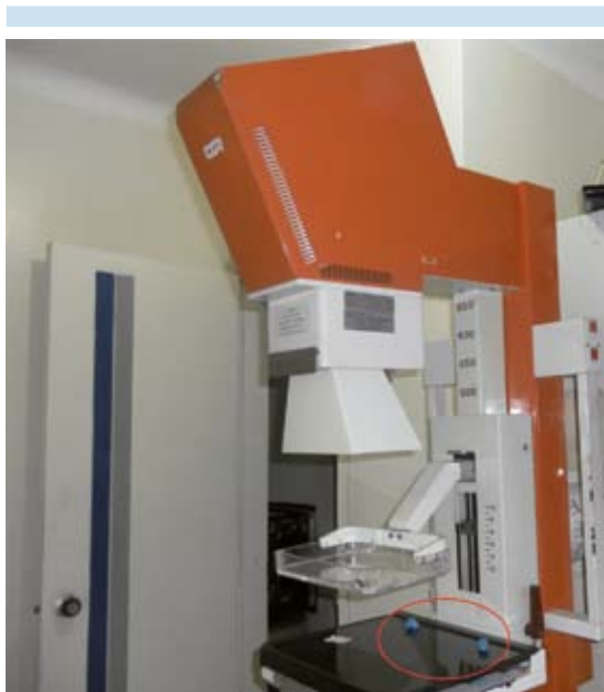
Figura 3. No conformidad en la inspección de la unidad de mamografía. Se utilizaba plastilina para asegurar el chasis en su posición cuando se rotaba el gantry de la unidad (visita inicial).
